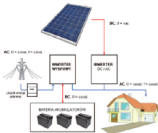
Rysunek 27. Schemat instalacji mieszanej 132 (oznaczenia: DC- prąd stały, AC-prąd przemienny, U- napięcie, f-częstotliwość, var.-zmiennie, const.- stałe)
